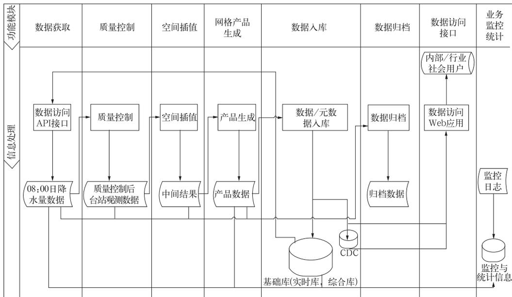
图 1 中国逐日格点降水量实时业务系统信息流程
